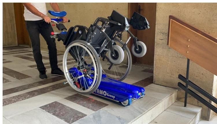
Устройството за изкачване на стълби за инвалидни колички се управлява от придружител и е предназначено да се движи нагоре и надолу по стълбите, докато студентът със специфични двигателни потребности е седнал на инвалидна количка, прикрепена към устройството. Тъй като тези платформи за изкачване на стълби са мобилни, без необходимост от прикрепване към конкретно стълбище, могат да бъдат транспортирани и използвани на различни места в университетския комплекс.
